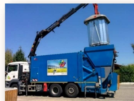
Collecte d'un conteneur semi-enterré avec un camion « Évolupac »
