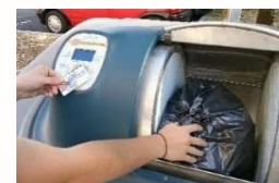
En bas, contrôleur d'accès et conteneurs semi-enterrés « Semimax »
